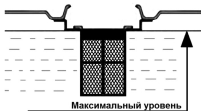
Рис. 8 Максимальный уровень топлива в топливном баке
