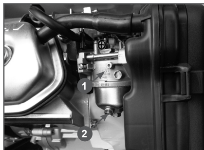
Рис. 17 Слив топлива из карбюратора
